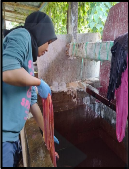
Pengkaji sedang mencelup kain didalam silikat untuk mematikan warna
