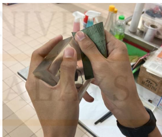
Rajah 4.30: Kerja kemas dilakukan pada blok resin.
