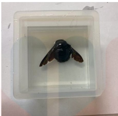
Rajah 4.27: Lapisan kedua resin dituang ke dalam acuan untuk memastikan spesimen melekat pada acuan.
