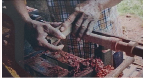
Gambar 4.21: Menggunakan kertas pasir pada permukaan batang serunai
