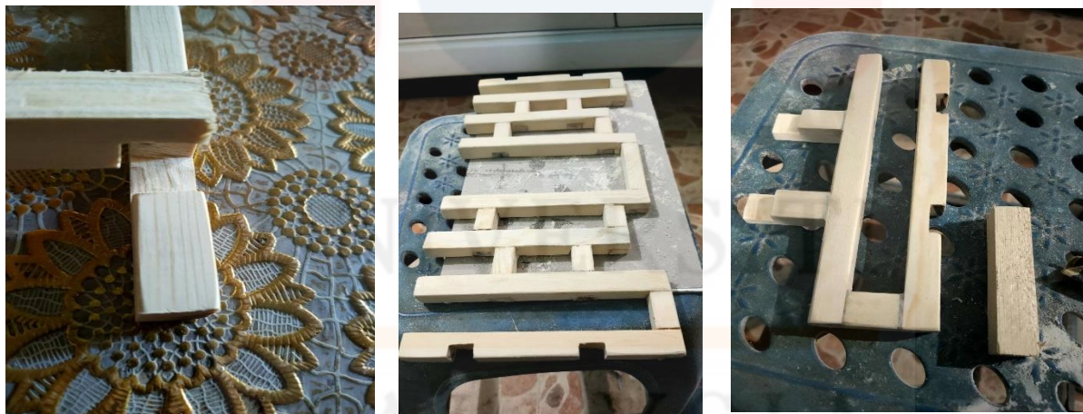
Rajah 4.9.2 : Menunjukkan proses pencantuman kaki meja penceramah yang berkonsepkan tanggam.
