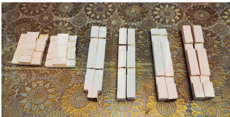
Rajah 4.9.1 : Menunjukkan material batang kayu yang telah siap dipotong mengikut ukuran tanggam yang dikehendaki.
