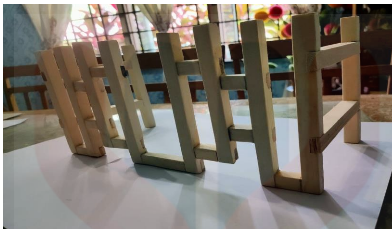
Rajah 4.9.3 : Menunjukkan kaki meja penceramah yang telah siap dipasang dan dibuat kekemasan bagi menampakan lagi kecantikan produk.
