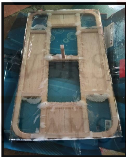
Rajah 4.9.12: Papan atas meja penceramah yang telah dituangkan epoxy dan bermukaannya telah kering namun akan ade sedikit kecacatan iaitu akan menimbulkan buih-buih kerana dalam material kayu mengandungi rongga-rongga atau lubang yang akan menghasilkan buih.
