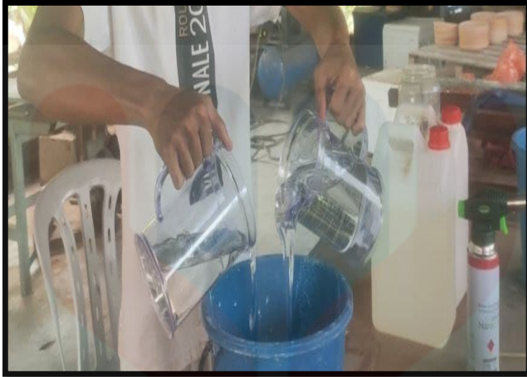
Rajah 4.9.7: Menunjukkan setelah sekatan resin dan hardener mencukupi mengikut sukatan maka ia akan dicampur ke dalam satu bekas yang lebih besar.
