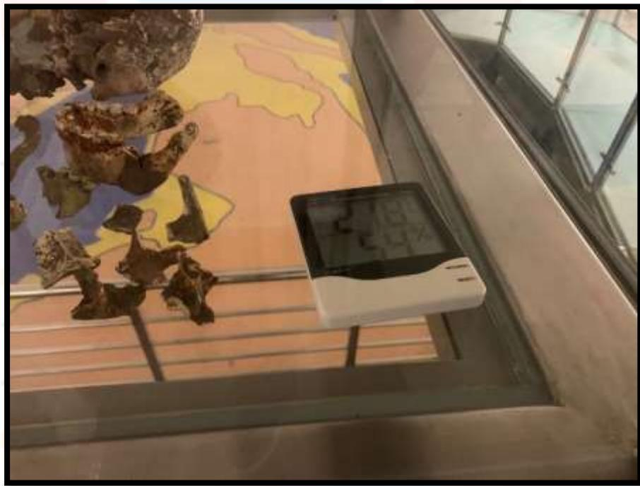
Rajah 4.4: Alat *Thermohygrometer*.
