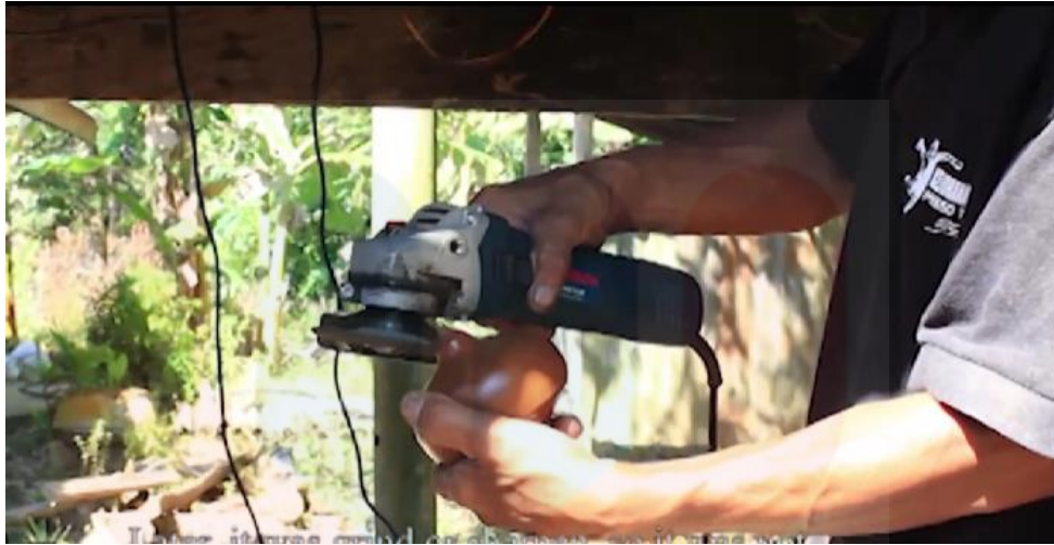
Gambar 16: Menunjukkan penggunaan mesin pencanai untuk menajamkan paksi gasing
