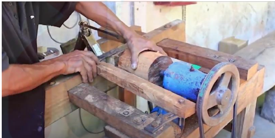
Gambar 13: Mesin Pelarik Kayu yang digunakan untuk membentuk sebuah Gasing Pangkah
