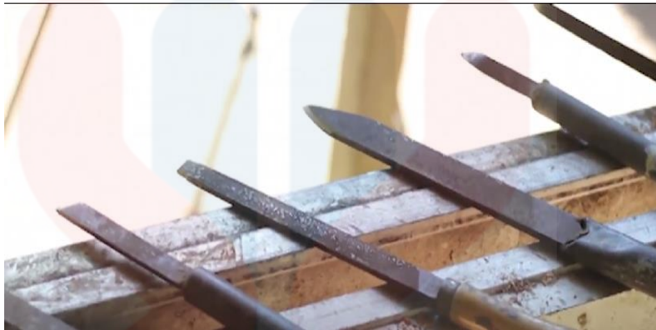
Gambar 14: Mata besi pencucuk yang digunakan dalam proses melarik Gasing Pangkah.
