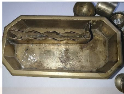
Rajah 4.25: Plak hitam (sulfida tembaga dan oksida) serta kotoran kapur pada bahagian dalam tepak
