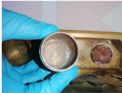
Rajah 4.27: Pengaratan di bahagian dalam bekas meletakkan bahan sirih
