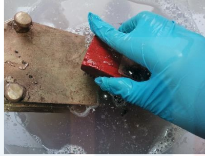
Rajah 4.33: Pembersihan menggunakan air sabun
