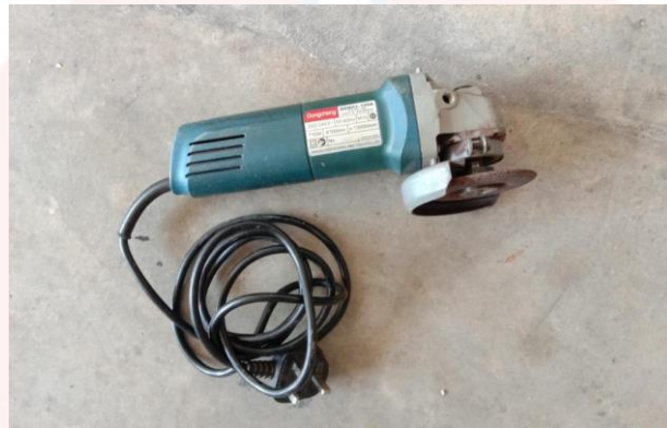
Rajah 4.47: Mesin pencanai elektrik (mudah alih)
