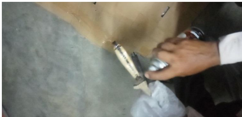
Rajah 4.45 : Cat penyembur disembur pada hulu kerambit
