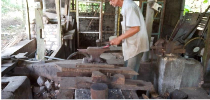
Rajah 4.23 : Besi ditempa dengan menggunakan penukul
