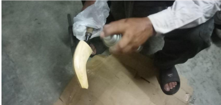
Rajah 4.44: Sarung kerambit disembur cat penyembur
