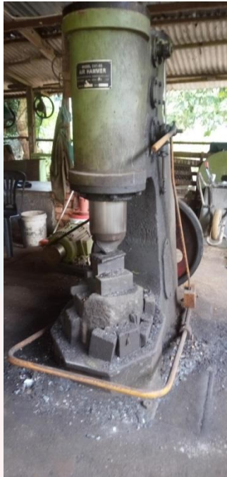
Rajah 4.11 : Mesin air hammer
