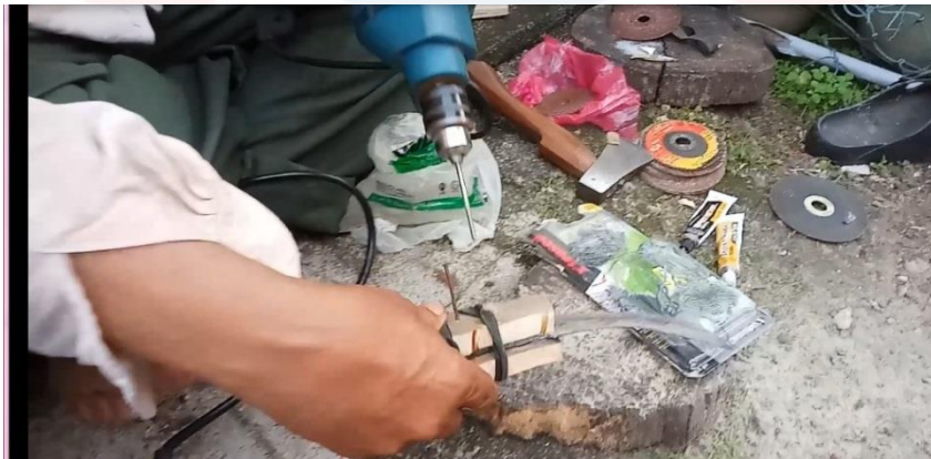
Rajah 4.37 : Proses menggerudi lubang pada hulu kerambit
