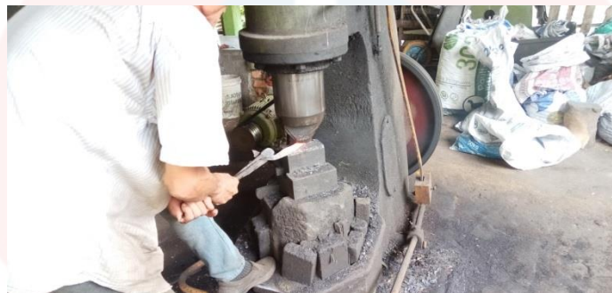
Rajah 4.22 : Besi ditempa dengan menggunakan mesin air hammer .
