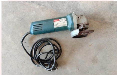
Rajah 4.15 : Mesin pencanai elektrik (mudah alih)
