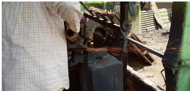
Rajah 4.24 : Bilah kerambit dicanai dengan menggunakan mesin pencanai elektrik (mudah alih).
