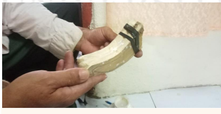
Rajah 4.32 : Sarung kerambit yang telah selesai disapu gam kayu.
