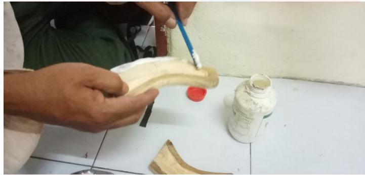
Rajah 4.31 : Gam kayu disapu pada bahagian tepi sarung kerambit.
