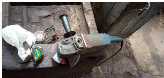
Rajah 4.3 : Mesin pencanai elektrik ( mudah alih )
