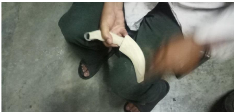
Rajah 4.41 : Permukaan sarung kerambit dilicinkan.
