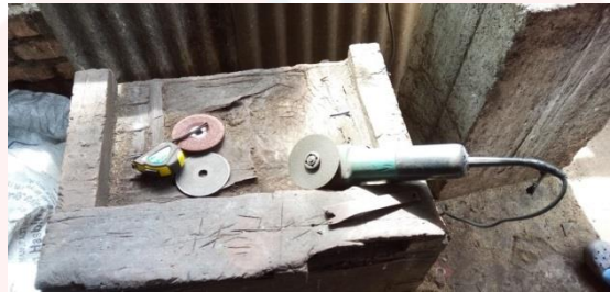
Rajah 4.2 : Mesin pencanai elektrik ( mudah alih )
