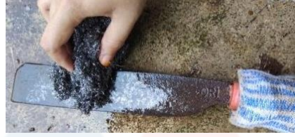
Rajah 4.10 : Bahagian mata (besi) senjata golok digosok dengan berus keluli (Sumber : Kajian Lapangan (11/08/2021))
