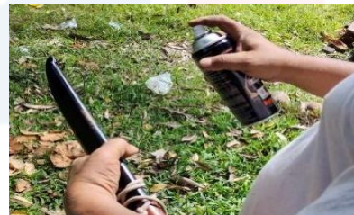
Rajah 4.18 : Bahagian sarung (kayu) senjata golok disembur dengan spray kayu
