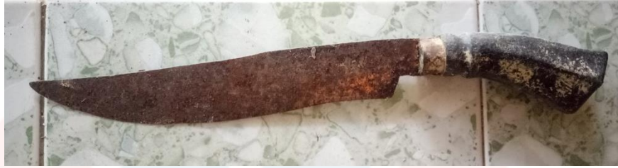
Rajah 4.3 : Kerosakan berkarat pada mata besi golok
