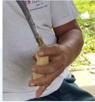
Rajah 4.21 : Bahagian hulu (kayu) dan puting (besi) golok dicantumkan
