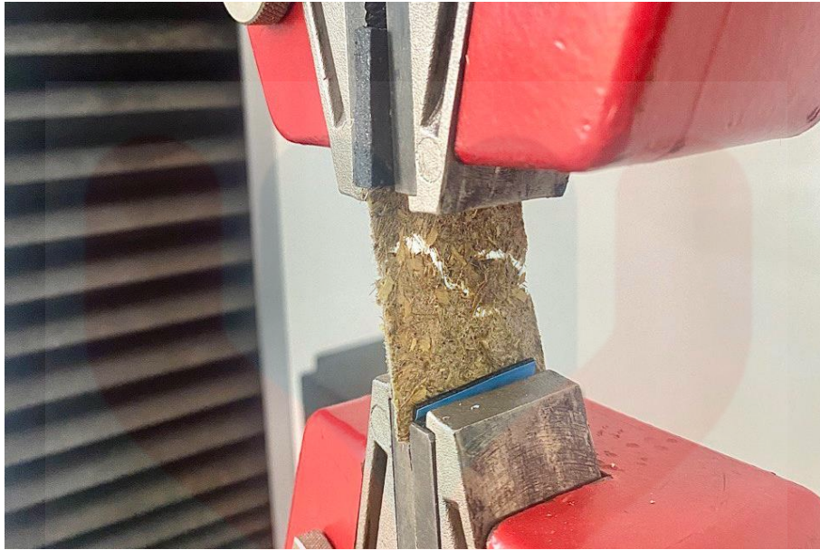
Rajah 3.4: Ujian Kekuatan regangan kertas daripada gentian nanas menggunakan Universal Testing Machine
