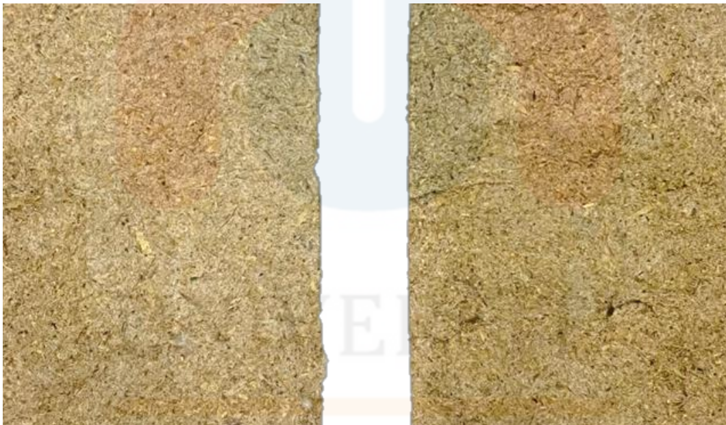
Rajah 4.1: Gambar menunjukkan kertas buatan tangan berukuran 12.7cm × 8.9cm yang dihasilkan daripada gentian nanas
