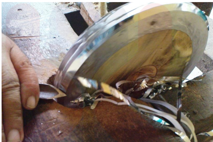
Gambar 13. Proses melarik timah.
