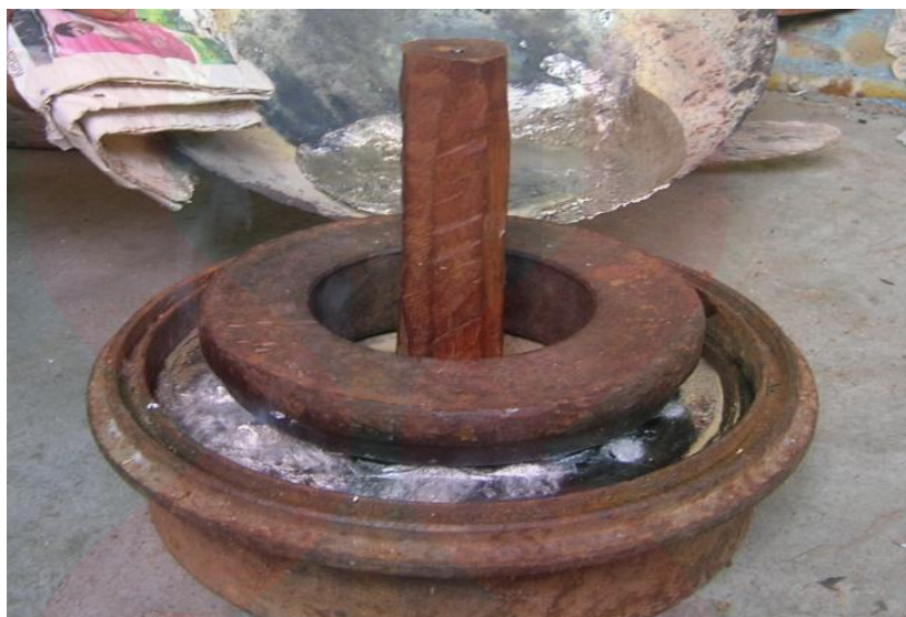
Gambar 11. Proses menuang timah ke dalam acuan.
