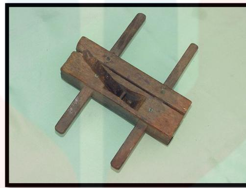
Gambar 11: Ketam di gunakan untuk menipiskan ketebalan kayu
