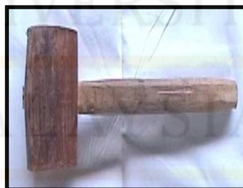
Gambar 12: Tukul kayu di gunakan untuk mengetuk ketika kerja-kerja pemasangan bahagian-bahagian perabot
