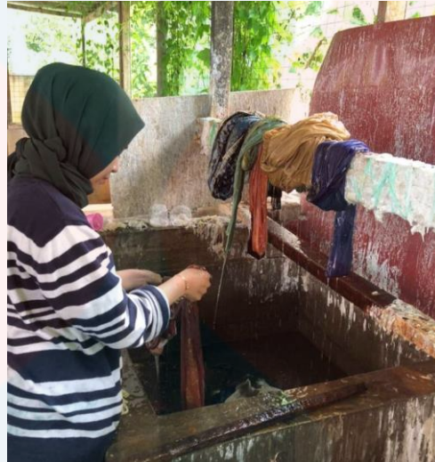
Rajah 4.7.6: Proses Merendam Kain Ke Dalam Silicate
