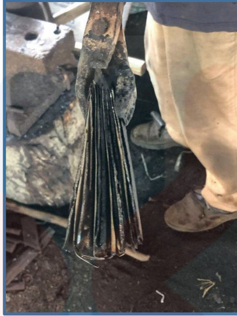
Rajah 4.2: Besi Tawar Disusun Bertingkat untuk Dilekatkan
