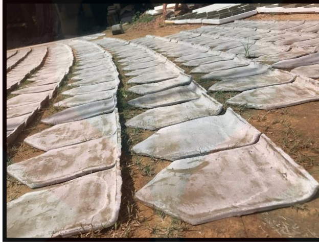
Rajah 29. Proses Pengeringan Atap Singgora Berbentuk V
