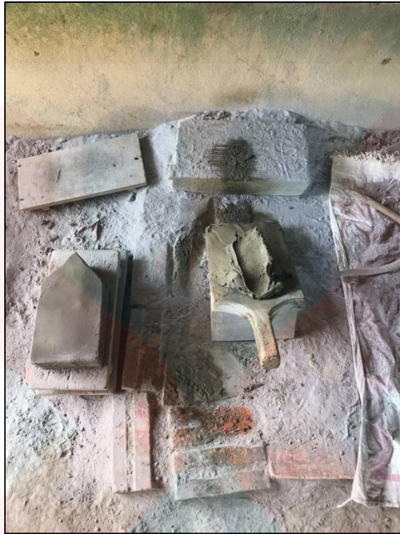
Rajah 2.14 : Bentuk acuan atap singgora yang digunakan oleh Kraf Arap Singgora, Bachok
