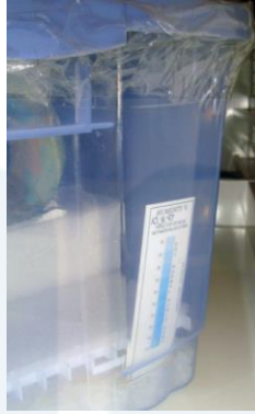
Rajah 4.12 alat sukatan suhu untuk proses pemantauan suhu dan kelembapan dengan berterusan
