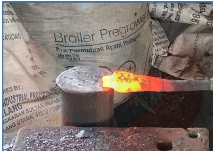
Gambar 4.5: Proses penghasilan puting keris
