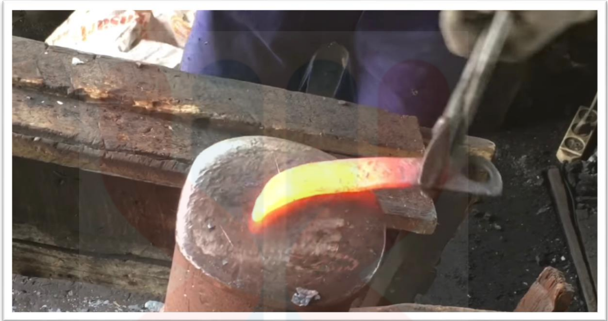
Gambar 4.7 : Proses menempa bilah kerambit
