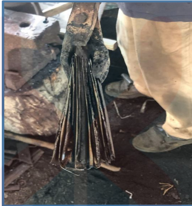
Gambar 4.3: Besi tawar yang disusun
