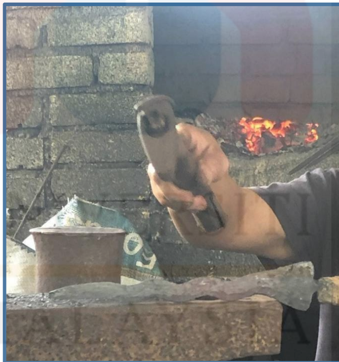
Gambar 4.6: memastikan luk selari
